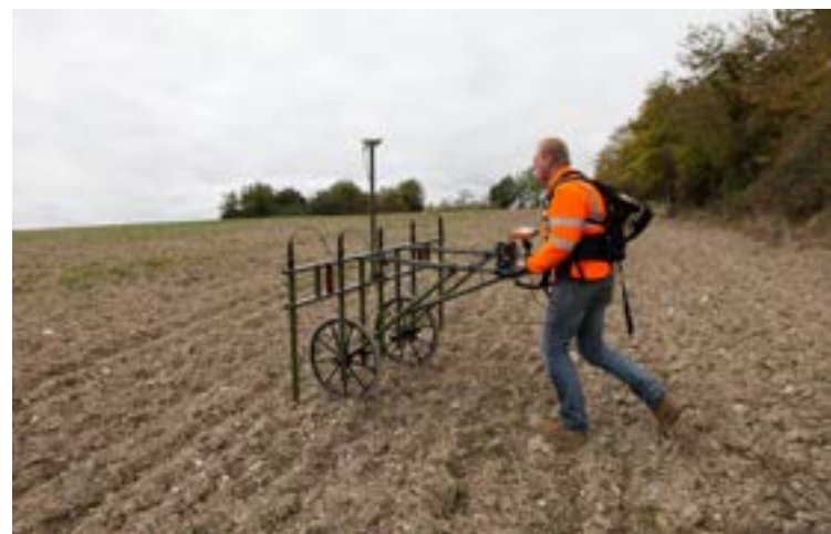
Opération de prospection magnétique, Site du Petit Camp de César (La Roche-Blanche)
